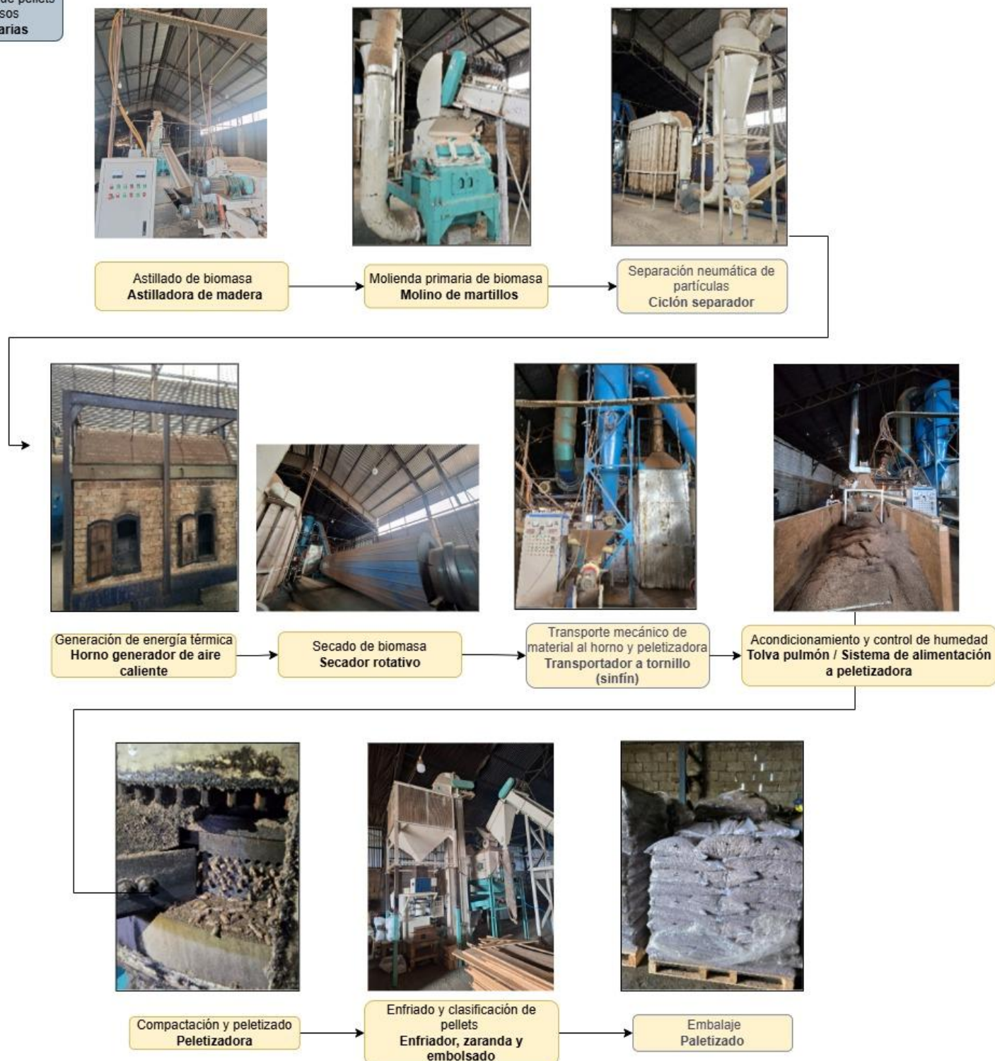
Figure 14: Detalle de equipamiento utilizado. Fuente: Elaboración propia.
