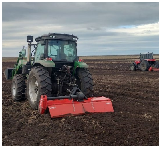
Imagen 3: a) Arado de rejas trabajando. b) 2 Rotovators realizando refinado de cama de siembra.
