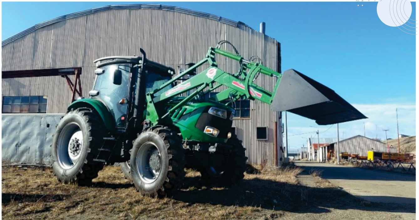
Imagen 3: Tractor de 160 HP con pala frontal, marca Chery by lion
