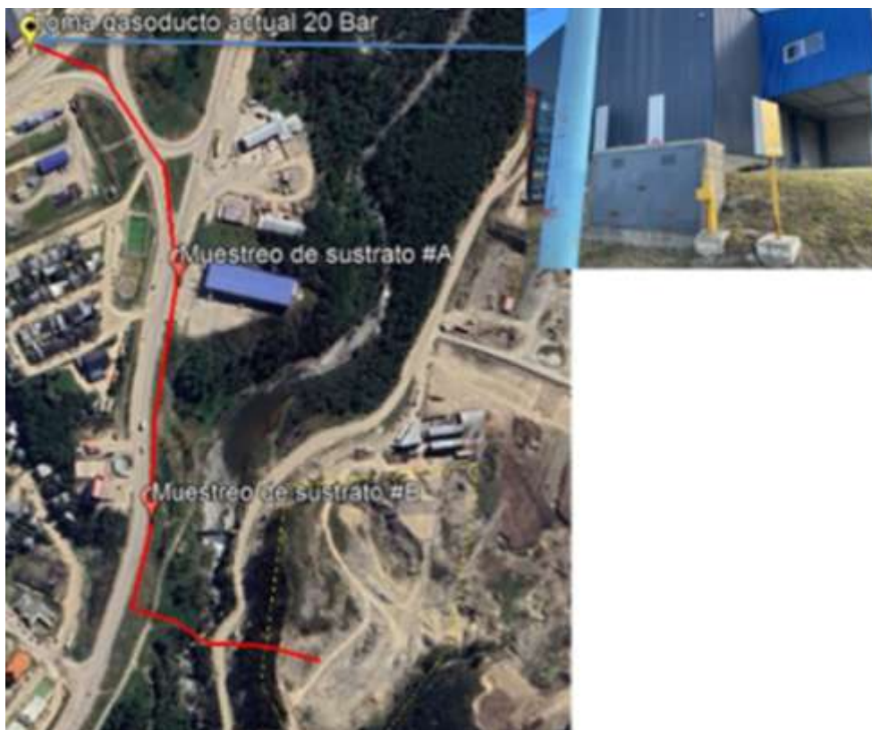
Imagen 3: Traza propuesta para el gasoducto de alimentación para la nueva Central Termoeléctrica con el gasoducto principal de Camuzzi.
