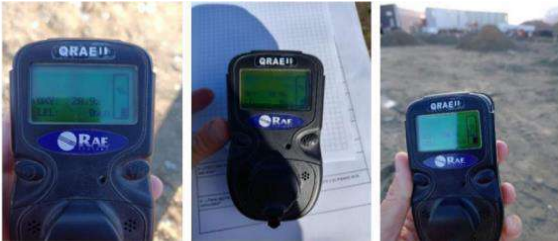
Imagen 38 - Mediciones de riesgo de explosión. Relevamiento de campo 17.4.23
