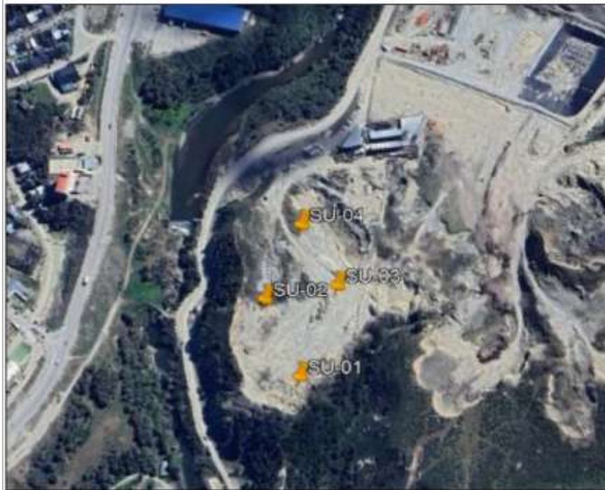
Imagen 47 - Mediciones de calidad del suelo - Fuente: Estudio de calidad del suelo. ANEXO 10 del EIAS
