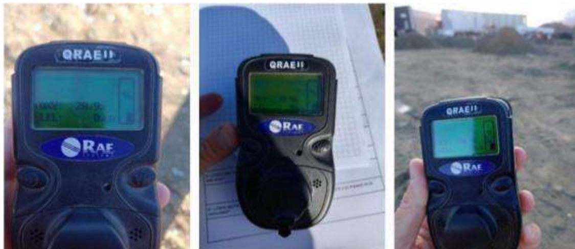
Imagen 44 - Mediciones de riesgo de explosión. Relevamiento de campo 17.4.23
