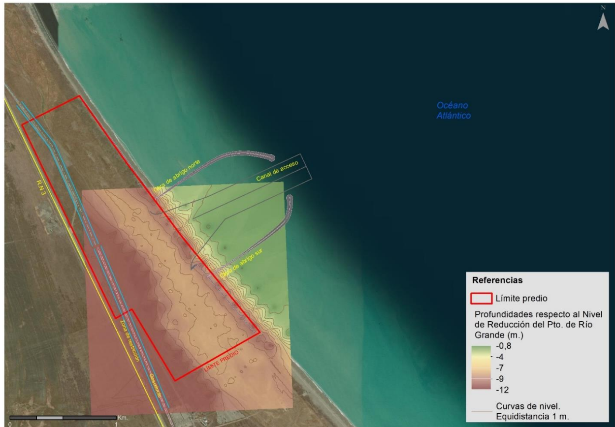
Figura 20. Resultado del relevamiento topográfico realizado por Bonfill y Asoc. en octubre 2022..
