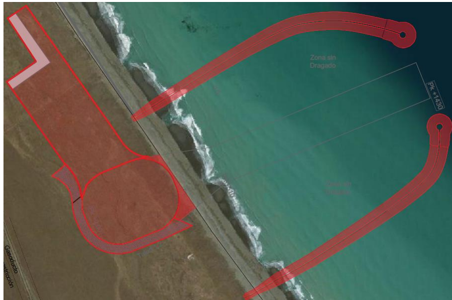
Figura 8. Construcción de las obras de abrigo.
