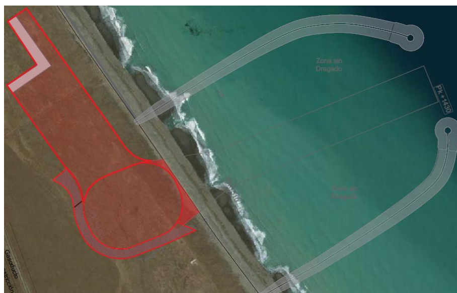
Figura 7. Excavación preliminar para extracción de material de elaboración de bloques de suelo cemento para el núcleo de las obras de abrigo.
