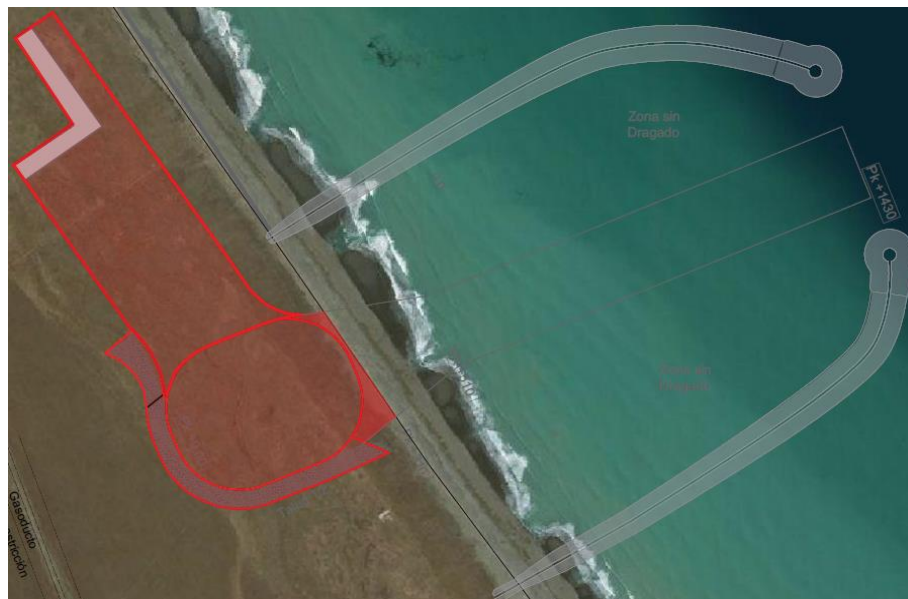
Figura 5. Excavación preliminar para extracción de material de elaboración de bloques de suelo cemento para el núcleo de las obras de abrigo.
