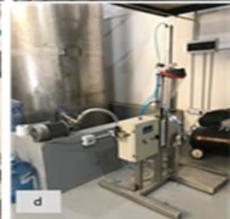
Enmienda líquida: Maquinaria para producir : a. Molino microlizador; b. digestores; c. buffers estacionarios; d. envasadora
