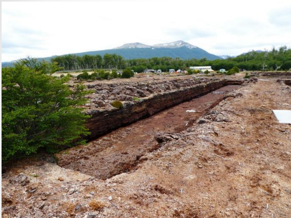
Método en zanjas o panes
