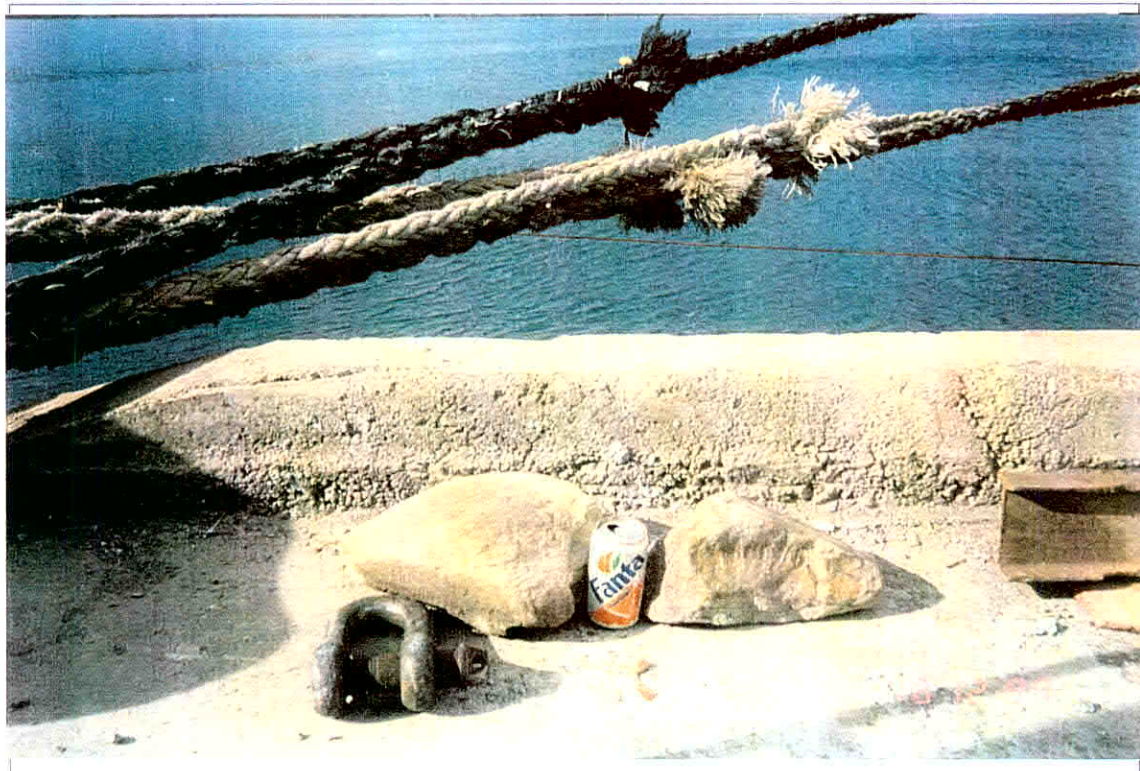
FOTO N° 4 : BOCHONES DE ROCA EXTRAIDOS DURANTE LA EXCAVACION DE PILOTES.
