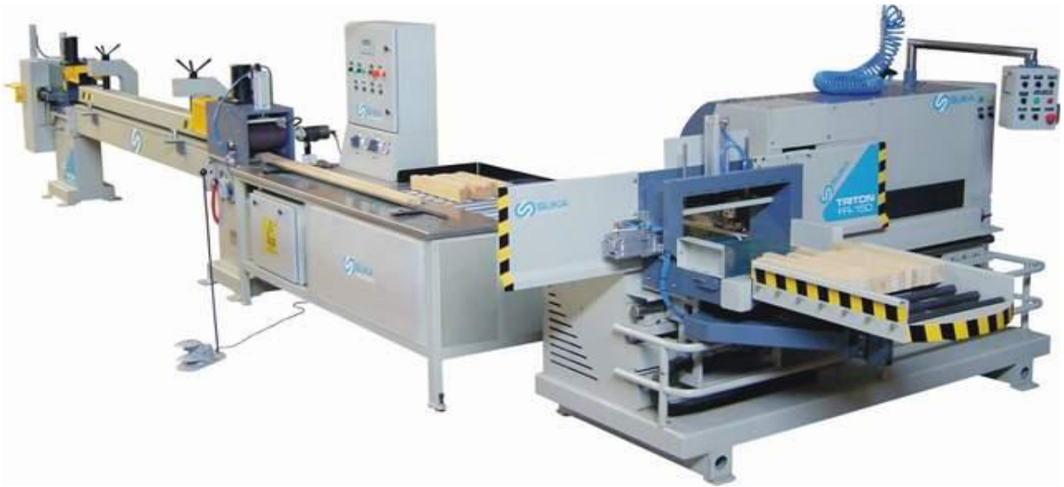
Figura I.12. Línea Finger Joint Suka 2005 INTI-Madera
