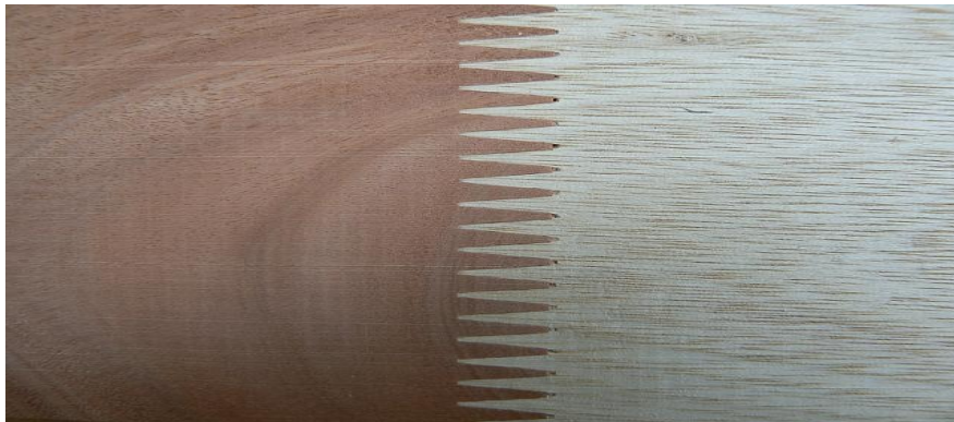
Figura I.13. Detalle de la unión finger (ACF) INTI-Madera
