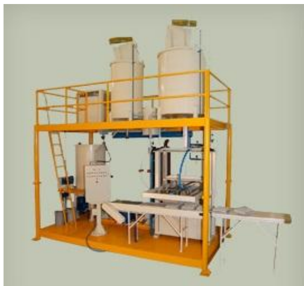
Figura I.16. Hidropulper y prensa INTI – Celulosa y Papel
